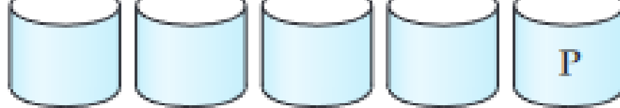
(d) RAID 3: bit-interleaved parity
